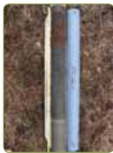
Prélèvement sur carottage. Dans les milieux humides, l'échantillonnage est essentiellement réalisé sous forme de séries continues obtenues par sondages et carottages.
