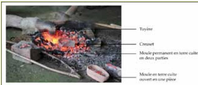
Photographie d'un foyer de fusion réalisée lors d'une journée expérimentale
