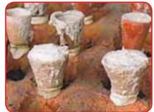
Saumure en cours de chauffage dans des augets afin d'obtenir des pains de sel
